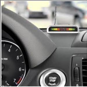
L'affichage au tableau de bord s'active lorsque la distance avec l'obstacle est inférieure ou égale à 2m.
