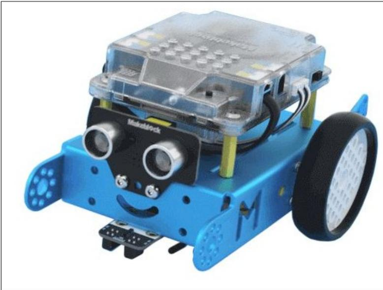
**Mbot** est un robot programmable. Il peut se déplacer en avant, en arrière et tourner à droite ou à gauche. Il peut émettre des sons et des signaux lumineux. Il peut aussi détecter des obstacles, suivre une ligne et recevoir des ordres d'une télécommande.
