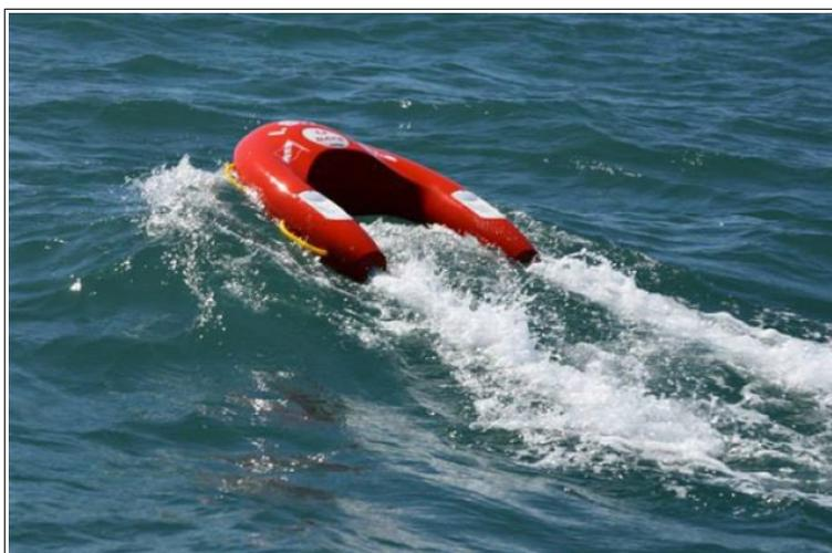
**La bouée de sauvetage de sauvetage télécommandée** est un petit robot de sauvetage de surface qui peut être utilisé à distance. Il peut être utilisé dans le sauvetage des chutes dans les piscines, les réservoirs d'eau, les rivières, la mer et les inondations.
