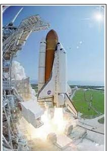
**Une navette spatiale**, dans le domaine de l'aéronautique, désigne conventionnellement un véhicule spatial pouvant revenir sur Terre en effectuant un atterrissage contrôlé à la manière d'un avion ou d'un planeur et pouvant être réutilisé pour une mission ultérieure. Une navette spatiale peut avoir plusieurs fonctions. Parmi elles, l'envoi de charges utiles en orbite.
