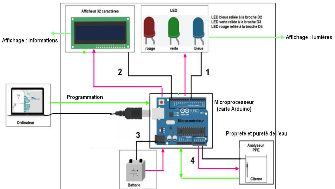
L'analyseur PPE (Pureté et Propreté de l'Eau) est piloté par une interface Arduino qui permet de vérifier la qualité de l'eau. Le système comporte les composants suivants :
