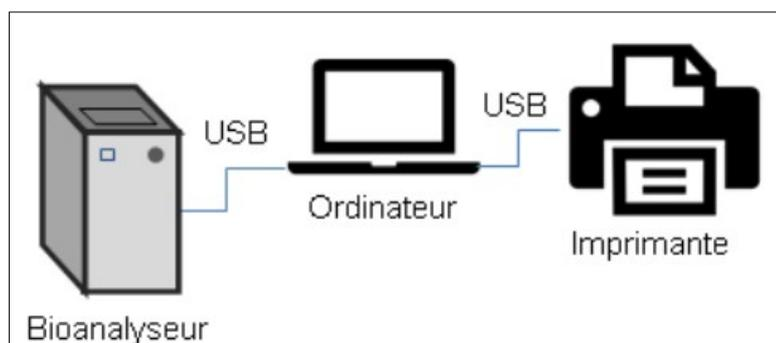
Le système est constitué d'un bioanalyseur, un ordinateur portable et une imprimante.
