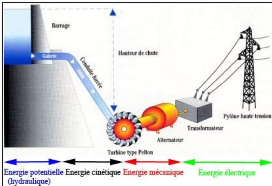
L'eau accumulée dans le barrage constitue une énergie potentielle disponible pour entraîner en rotation la turbine.
