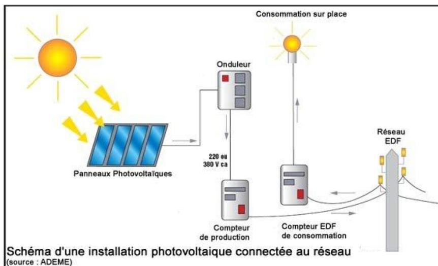
Les **panneaux solaires** captent l'énergie lumineuse du soleil et la transforme en énergie électrique. L'**onduleur** fait le lien entre les panneaux solaires et le réseau électrique. Il assure la transformation du courant continu des panneaux, en courant alternatif requis par le réseau.
